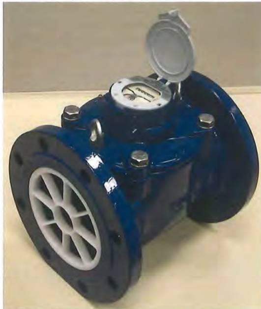
MeiStream DN 150 mit Trockenläufer-Zeiger-Rollenzählwerk MeiStream MS - D HRI, Strahlrichter, Deckelflansch aus Metall und Verplombung (Perspektivdarstellung)
