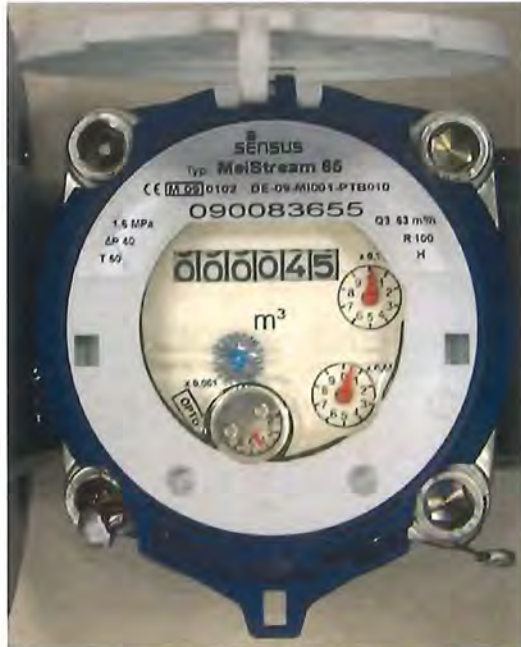
MeiStream DN 65 mit Deckelflansch aus Metall, Kopfring mit allen signifikanten Zählerkenndaten, Konformitäts- und Metrologiekennzeichnung (geöffneter Schutzdeckel)
