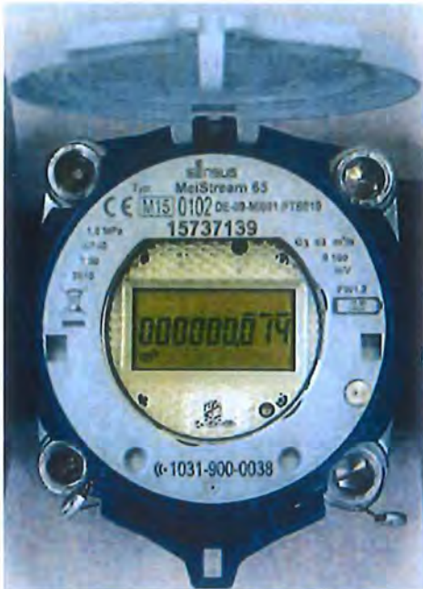
MeiStream DN 65 mit Deckelflansch aus Metall, Kopfring mit allen signifikanten Zählerkenn- daten, Konformitäts- und Metrologiekennzeichnung (geöffneter Schutzde- ckel)
