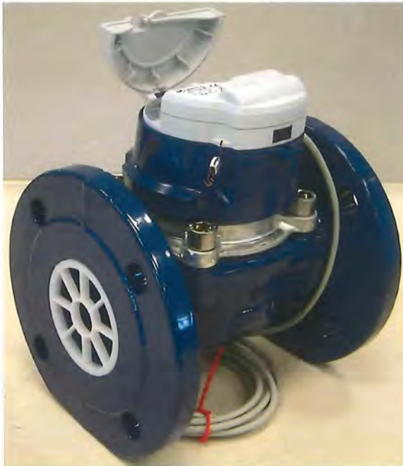
MeiStream DN 65 mit Trockenläufer- Zeiger- Rollenzählwerk MeiStream MS - D HRI, Deckel- flansch aus Metall, Impulsgebereinrichtungen HRI-Mei und OD (Perspektivdarstellung)
