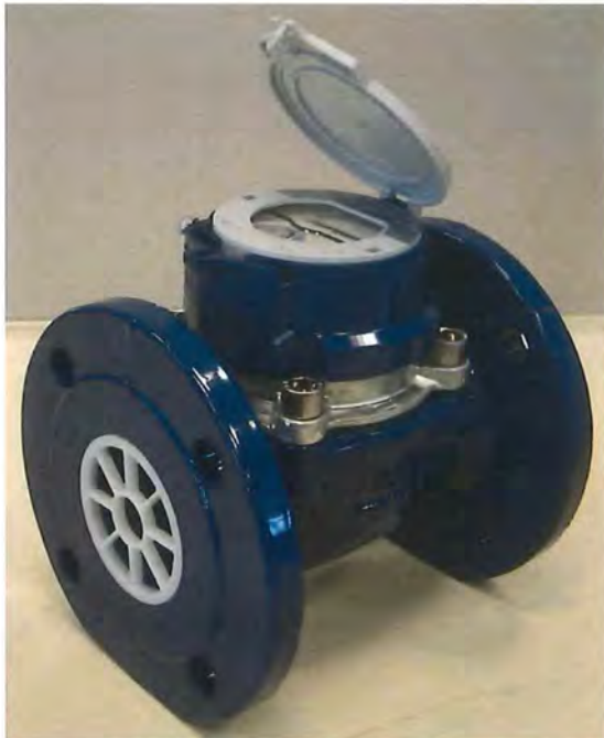
MeiStream DN 65 mit Trockenläufer-Zeiger-Rollenzählwerk MeiStream MS - D HRI, Strahlrichter, Deckelflansch aus Metall bzw. Kunststoff und Verplombung (Perspektivdarstellung)
