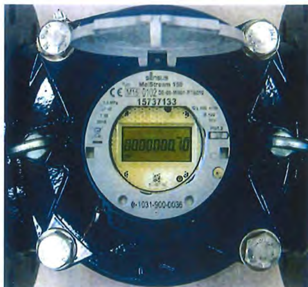
MeiStream DN 150 mit Deckelflansch aus Metall, Kopfring mit allen signifikanten Zählerkenn- daten, Konformitäts- und Metrologiekennzeichnung (geöffneter Schutzdeckel)
