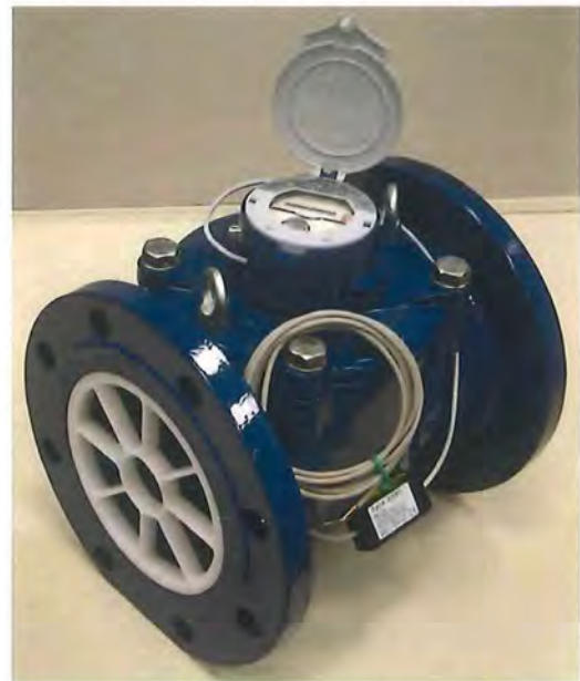
MeiStream DN 150 mit Trockenläufer- Zeiger- Rollenzählwerk MeiStream MS - D HRI, Deckel- flansch aus Metall, Impulsgebereinrichtungen HRI-Mei und OD (Perspektivdarstellung)
