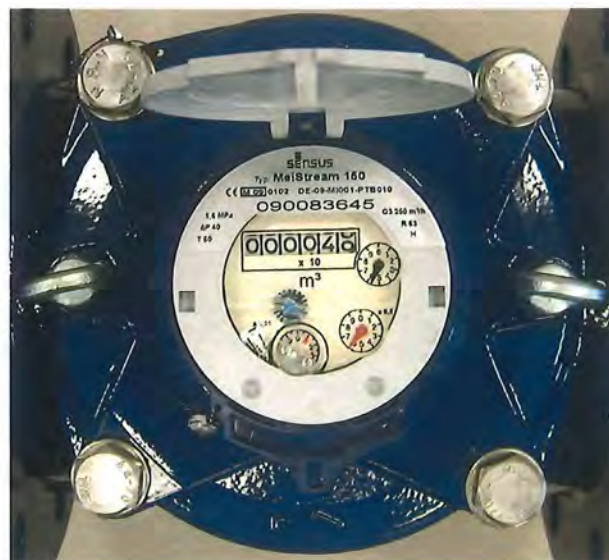
MeiStream DN 150 mit Deckelflansch aus Metall, Kopfring mit allen signifikanten Zählerkenndaten, Konformitäts- und Metrologiekennzeichnung (geöffneter Schutzdeckel)
