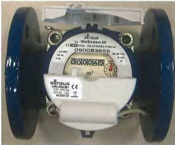
MeiStream DN 65 mit Deckelflansch aus Metall und induktiver Impulsgebereinrichtung HRI-Mei, Kopfring mit allen signifikanten Zählerkenndaten, Konformitäts- und Metrologiekennzeichnung (geöffneter Schutzdeckel)
