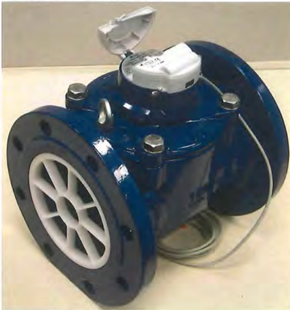
MeiStream DN 150 mit Trockenläufer- Zeiger- Rollenzählwerk MeiStream MS - D HRI, Deckel- flansch aus Metall, Impulsgebereinrichtungen HRI-Mei und OD (Perspektivdarstellung)
