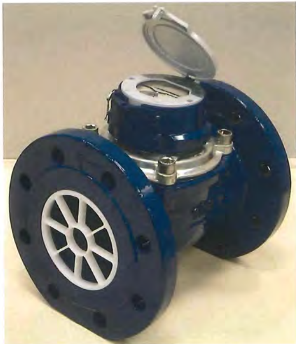
MeiStream DN 100 mit Trockenläufer-Zeiger-Rollenzählwerk MeiStream MS - D HRI, Strahl- richter, Deckelflansch aus Metall bzw. Kunststoff und Verplombung (Perspektivdarstellung)
