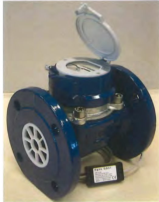
MeiStream DN 65 mit Trockenläufer- Zeiger- Rollenzählwerk MeiStream MS - D HRI, Deckel- flansch aus Metall, Impulsgebereinrichtungen HRI-Mei und OD (Perspektivdarstellung)
