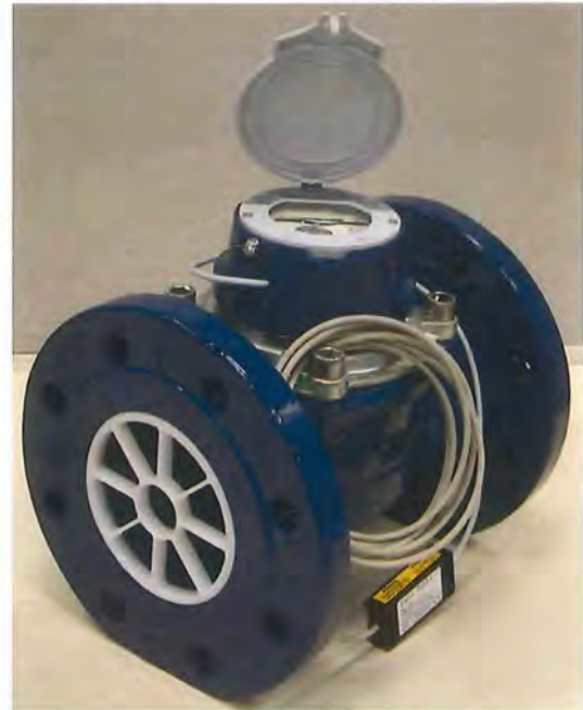
MeiStream DN 100 mit Trockenläufer- Zeiger- Rollenzählwerk MeiStream MS - D HRI, Deckel- flansch aus Metall, Impulsgebereinrichtungen HRI-Mei und OD (Perspektivdarstellung)
