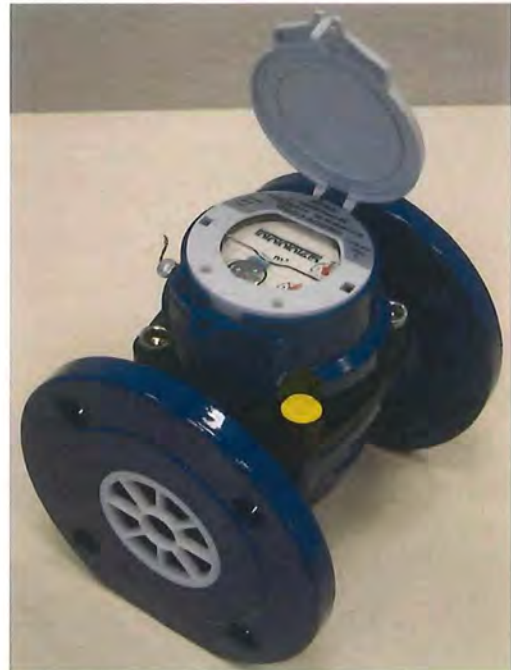
MeiStream DN 65 mit Trockenläufer-Zeiger-Rollenzählwerk MeiStream MS - D HRI, Strahlrichter, Deckelflansch aus Metall bzw. Kunststoff und Verplombung (Perspektivdarstellung)
