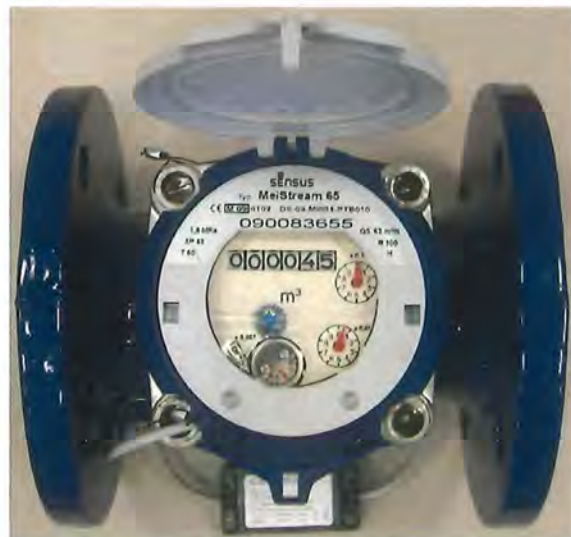
MeiStream DN 65 mit Deckelflansch aus Metall und optoelektronischer Impulsgebereinrichtung OD, Kopfring mit allen signifikanten Zählerkenndaten, Konformitäts- und Metrologiekennzeichnung (geöffneter Schutzdeckel)
