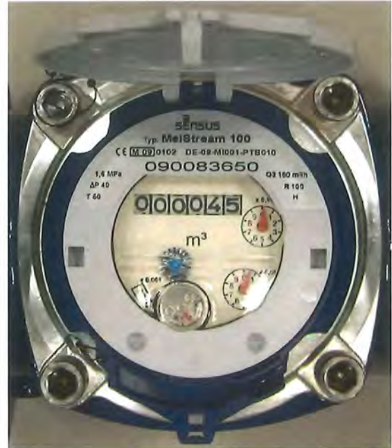
MeiStream DN 100 mit Deckelflansch aus Metall, Kopfring mit allen signifikanten Zählerkenndaten, Konformitäts- und Metrologiekennzeichnung (geöffneter Schutzdeckel)
