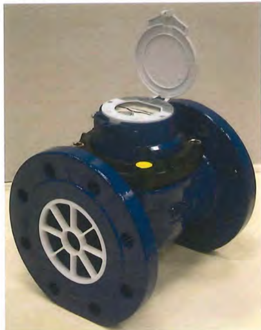
MeiStream DN 100 mit Trockenläufer-Zeiger-Rollenzählwerk MeiStream MS - D HRI, Strahl- richter, Deckelflansch aus Metall bzw. Kunststoff und Verplombung (Perspektivdarstellung)
